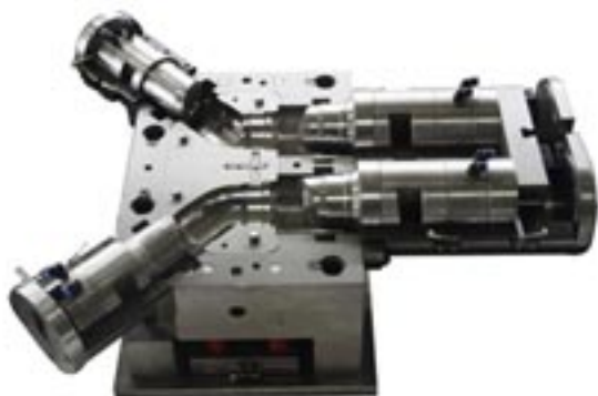
Extrusion-soufflage de conduits à formes complexes en polyalphaoaléfines, pour l'aéronautique
