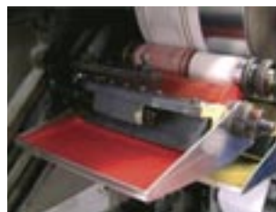
Nettoyage des encres en flexographie
